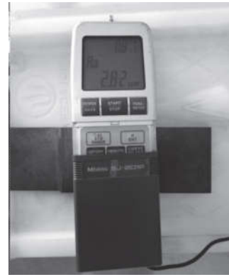
Hình 8. Độ nhám trên bề mặt khuôn sau khi phay CNC
